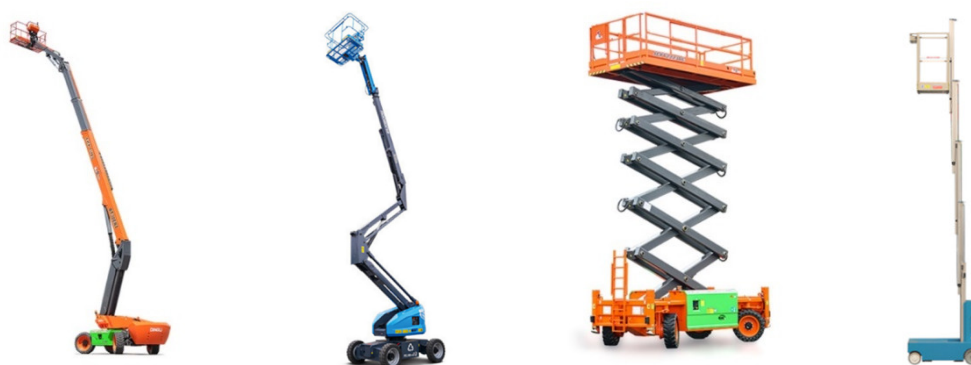
(a) Straight arm type (b) Curved arm type (c) Scissor type (d) Mast column type
